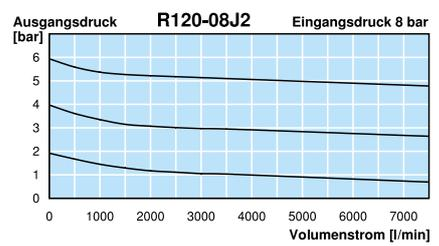
\*1 bei 8 bar Eingangsdruck, 6 bar Ausgangsdruck und 1 bar Druckabfall
